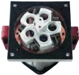
Bornas de conexión en bases de 200 A para secciones de conductor de 70 a 150 mm<sup>2</sup>, con 250 A y 400 A para secciones de conductor de 70 a 185 mm<sup>2</sup> en caso de conductores flexibles y de 70 a 240 mm<sup>2</sup> en caso de conductores de uno o varios hilos.
