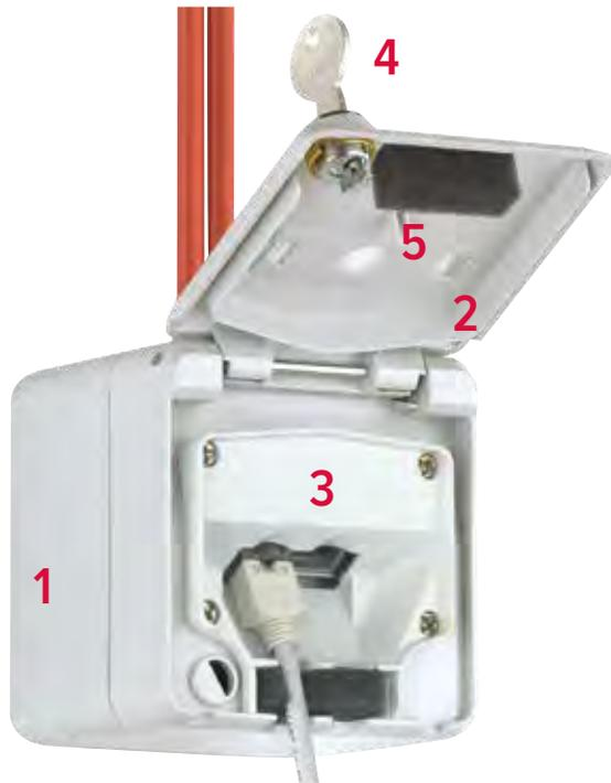
**1** La parte inferior del chasis se puede girar 180 grados para poder introducir los cables desde arriba o desde abajo sin operaciones adicionales.
